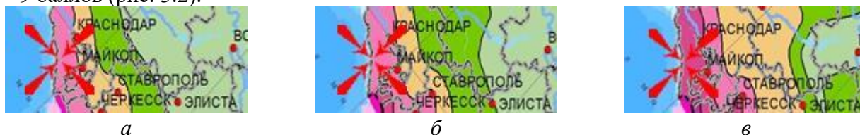
Рисунок 3.2 – Характеристика сейсмичной активности района в соответствии с комплектом карт ОСР-2016 (А (а), В (б), С (в))
