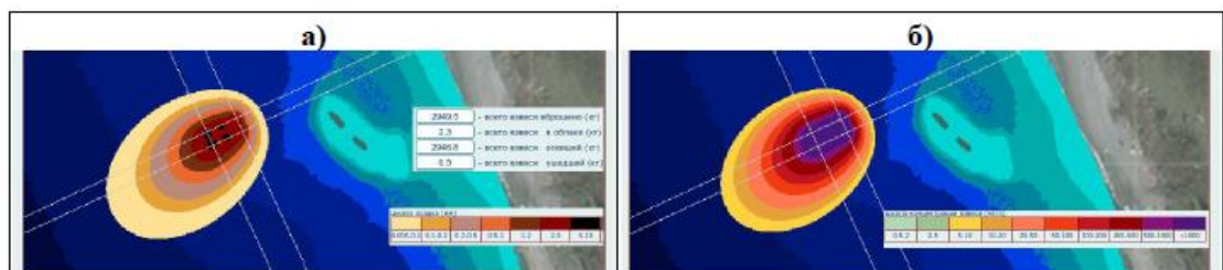
Рисунок 40 — Толщина образовавшегося осадка (а) и площади дна под «протёкшими объёмами» с пороговыми концентрациями (б) при устройстве котлована головной части буны №3
