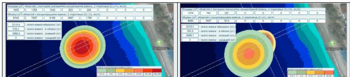
Рисунок 56 — Концентрация взвеси через 6,7 час и 14,0 час после окончания работ при устройстве котлована головной части буны №5
